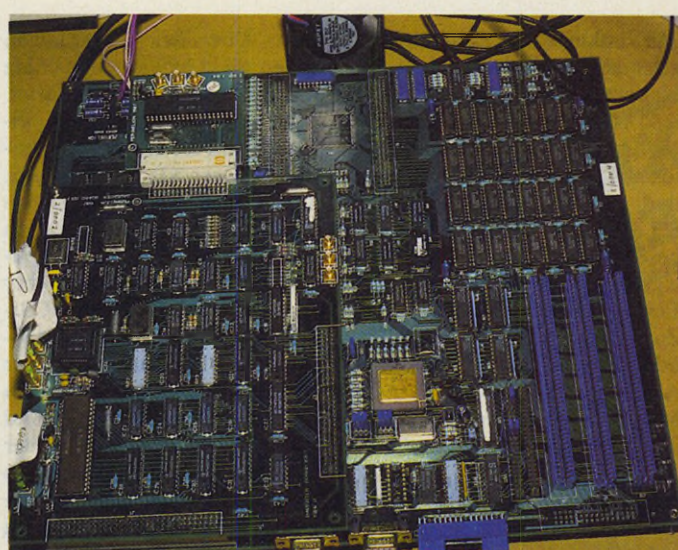
Die ABAQ-Platine wird bis zur Produktion noch einige Änderungen erfahren. Rechts sind die drei Erweiterungs-Slots zu erkennen.
