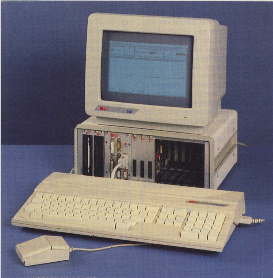
Im Gehäuse unseres Test-190ST ist noch Platz für sechs weitere Einschübe
