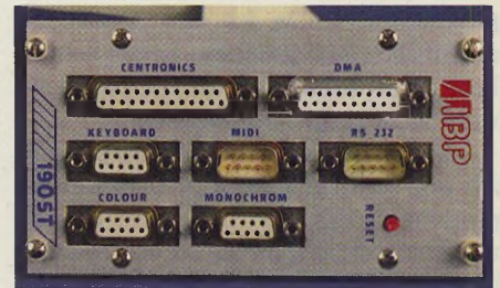
Die Schnittstellen erhielten teilweise stabilere neue Buchsen
