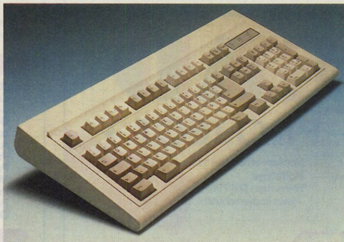
XT-Tastaturen wie diese Cherry-Tastatur laufen dank ST__Tast problemlos am ST
