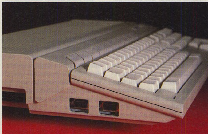
Den neuen 1040 STE kennzeichnen zwei weitere Anschlußbuchsen für Joysticks
