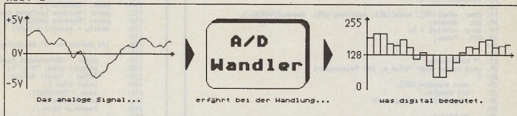
So sieht das analoge Signal vor und nach der Wandlung aus
