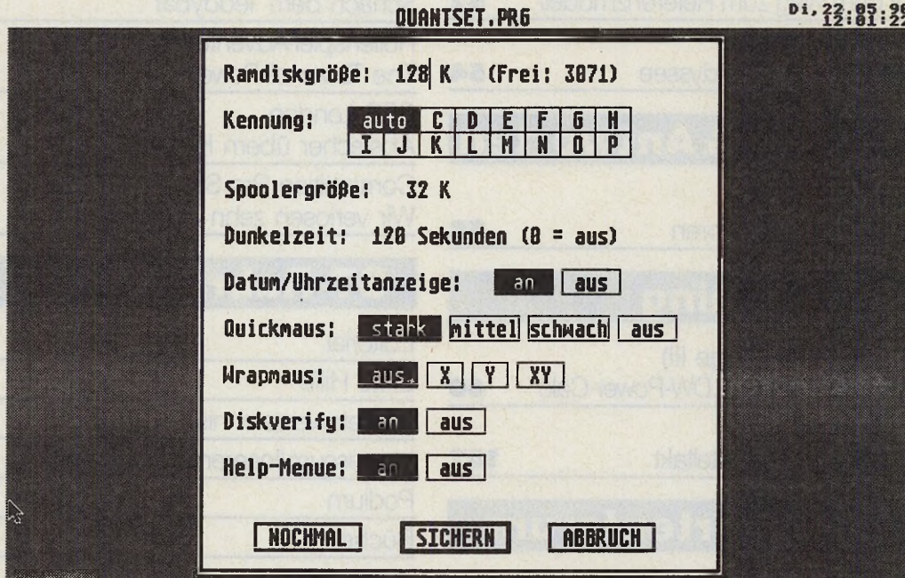
Die Konfiguration von »Quantos«: Bildschirmskopie auf 24-Nadel- oder Laserdrucker bei wählbarem Bildausschnitt. Die RAM-Disk- und Spoolergröße läßt sich nachträglich variieren.
