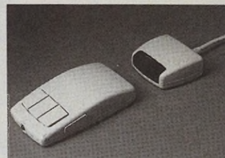
Die Infrarot-Maus arbeitet ohne Kabel
