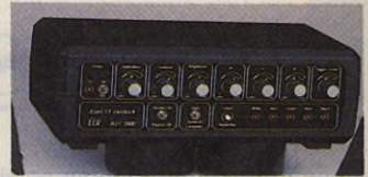
Genlock ELV AST 7000. Die Regler dienen zum Abgleichen von RGB, dem Triggerlevel, von Kontrast und Helligkeit.
