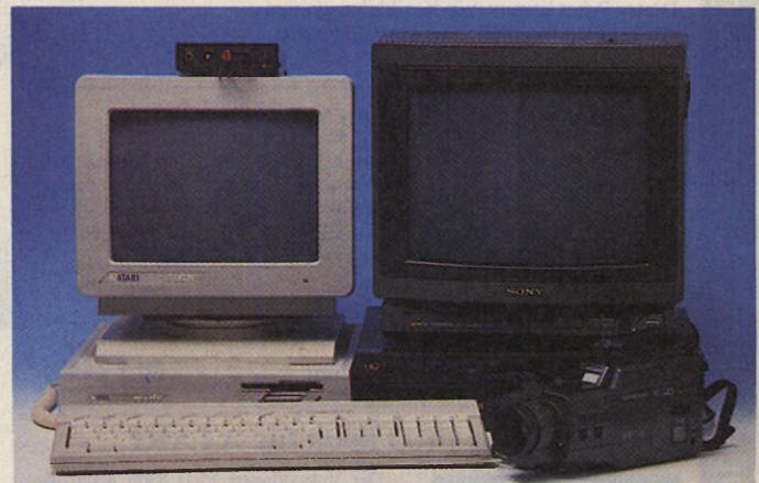
Genlock ELV AST 7000. Die Regler dienen zum Abgleichen von RGB, dem Triggerlevel, von Kontrast und Helligkeit.
