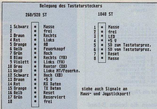
Die Belegung des Tastatursteckers verrät den Zusammenhang von Maus und Joystick mit dem Tastaturprozessor
