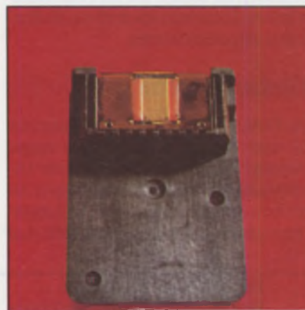
Der Druckkopf von unten. In der Mitte zwei Reihen à 25 Düsen.
