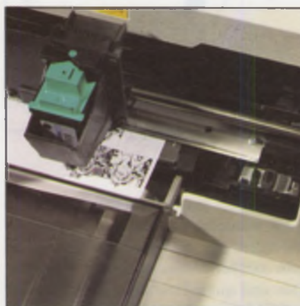
Das Innere des Deskjet PLUS. Links der Druckkopf, rechts dessen Verschluss.
