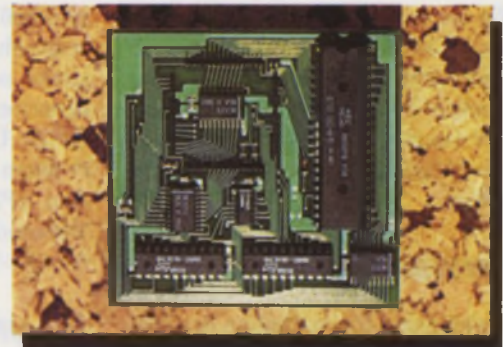
PC-Speed erweitert den ATARI STE zum MS-DOS-Rechner
