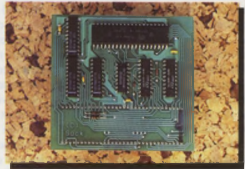
PC-Speed erweitert den ATARI ST zum MS-DOS-Rechner
