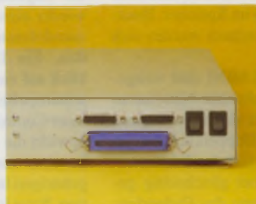
SCSI Schnittstelle an Geräterückseite herausgeführt
