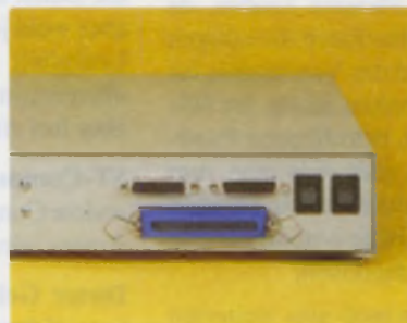
SCSI Schnittstelle an Geräterückseite herausgeführt
