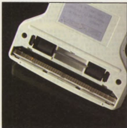
Unter den Bauch geschaut: Scan-Leiste beim Print Technik-Scanner
