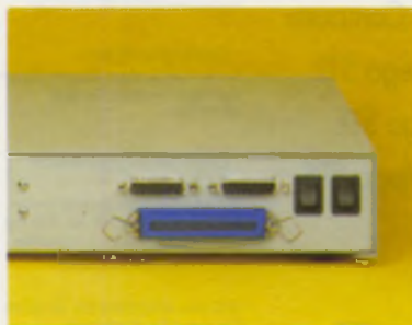
SCSI Schnittstelle an Geräterückseite herausgeführt
