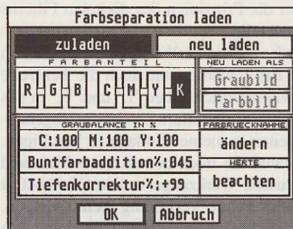
Bild 7: Bei der Farbseparation gestattet CRANACH Studio V die manuelle Änderung diverser Parameter.
