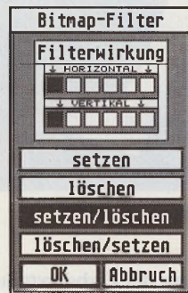
Bild 4: Der Bitmap-Filter entfernt vor der Vektorisierung störende Punkte.
