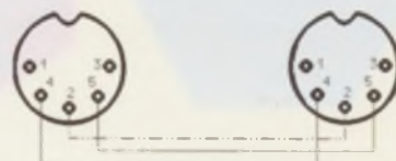
Abb.6: Es brauchen nur 3 Pins der Spoligen MIDI-Stecker miteinander verbunden werden.
