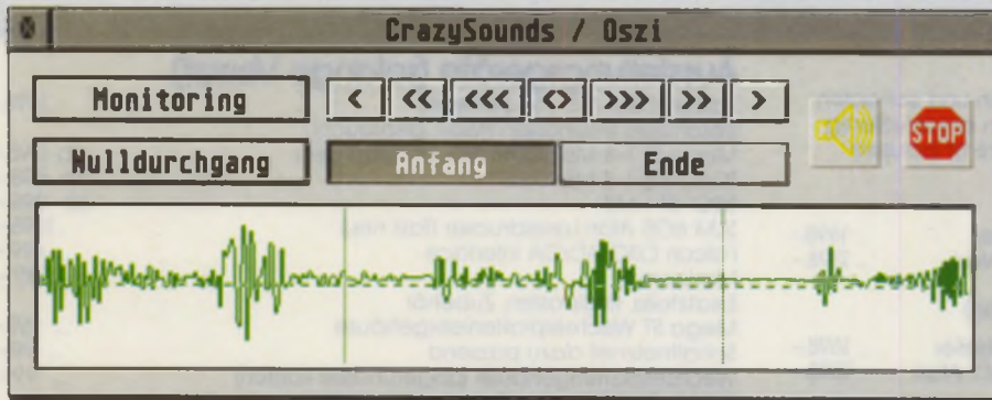
Mittels des Oszilloskops kann man digitale Samples sehr exakt schneiden.
