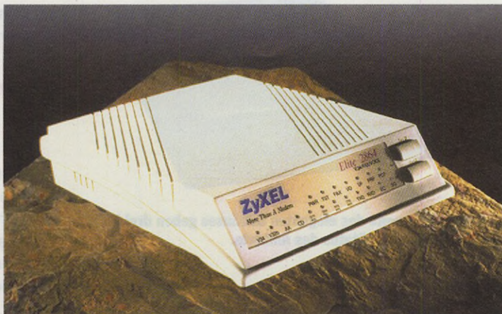
Das ZyXEL zeigt mit 21 LEDs an, was gerade in ihm vorgeht. An der rechten Seite sind zwei Klinkenbuchsen für den Anschluß eines Mikrofons und eines Boxenpaares vorhanden. Der Netzschalter ist in das externe Netzteil integriert.
