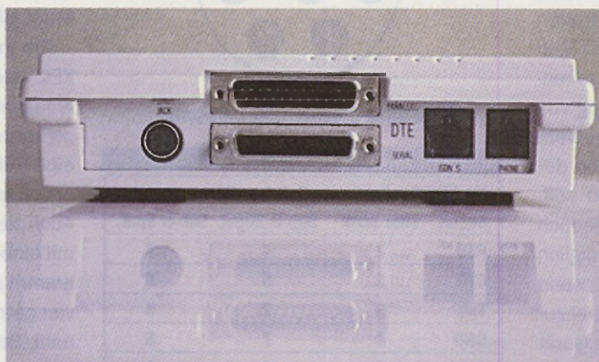
Die Anschlüsse an der Rückseite des ZyXEL sind beschriftet. Rechts neben der Stromversorgung sind die parallele und die serielle Schnittstelle übereinander angeordnet. Ganz rechts befindet sich eine Westernbuchse zum Anschluß an den S0-Bus und eine als a/b-Schnittstelle.
