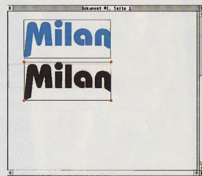
Schritt 2: Kopie des zu maskierenden Objektes komplett schwärzen.
